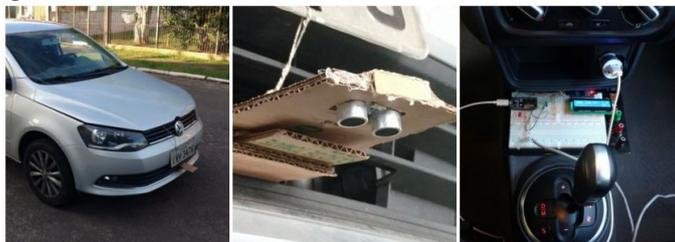
A Figura 4 mostra 3 fotos que exemplificam a instalação do sistema no veículo. A primeira mostrando a posição da instalação do sensor na parte frontal, a segunda mostrando o *case* criado e montado manualmente que envolve o sensor para apoiá-lo e protegê-lo, e a terceira a instalação da placa controladora no interior do veículo.
