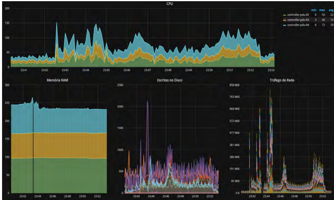
Figura 3. Dashboard de monitoração acompanhando um grupo de hosts, onde pode-se acompanhar a utilização de CPU, consumo de memória, escritas em disco e tráfego de rede enquanto uma aplicação Spark é executada em um cluster virtualizado.
